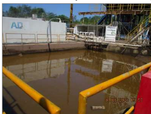
รูปที่ 2-2 บ่อกักเก็บเศษหินและกากน้ำโคลน (Cutting Pit) และบ่อกักเก็บน้ำปนเปื้อน (Waste Pit)
