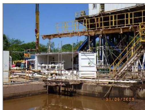
รูปที่ 2-2 บ่อกักเก็บเศษหินและกากน้ำโคลน (Cutting Pit) และบ่อกักเก็บน้ำปนเปื้อน (Waste Pit)
