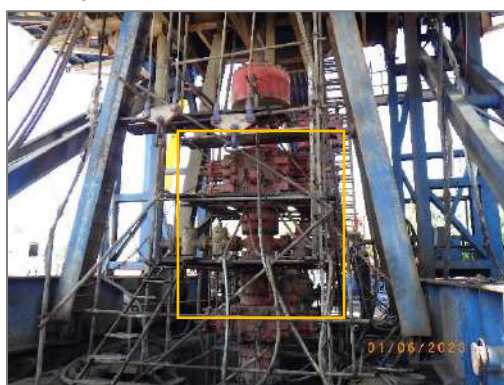
รูปที่ 2-20 อุปกรณ์ควบคุมการไหลพลุ่ง
